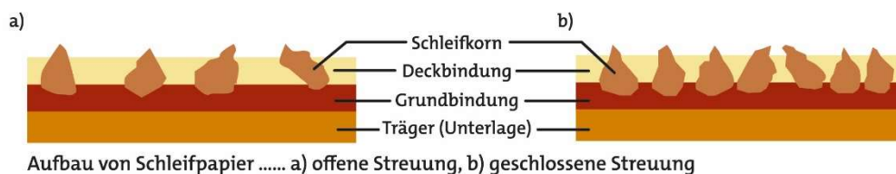
Obr. 1: Skladba brúsneho papiera a) otvorený posyp, b) uzavretý posyp (z odbornosti drevárskej technológie, 24. Edition Publisher Europe Teaching Materials)
